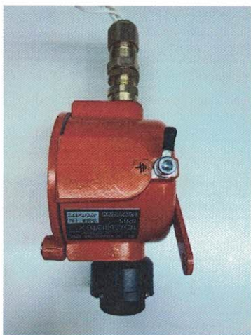
Рисунок 4 – Общий вид газоанализаторов ИГМ-10ИК и ИГМ-10Э
