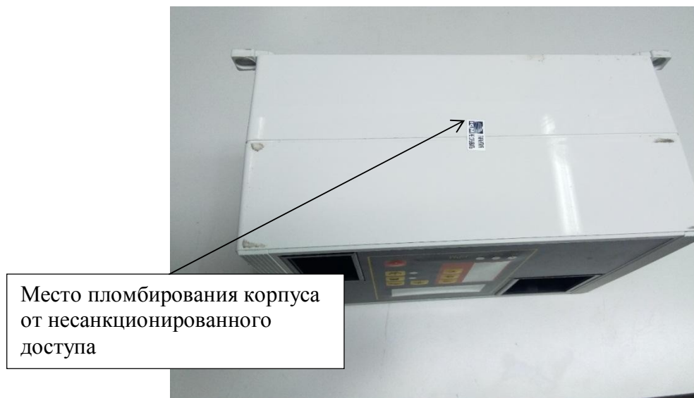
Рисунок 2 – Схема пломбирования газоанализаторов от несанкционированного доступа (модель 1011)
