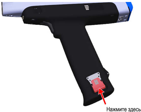
Рис. 3-10 Кнопка освобождения батареи с левой стороны ручки
