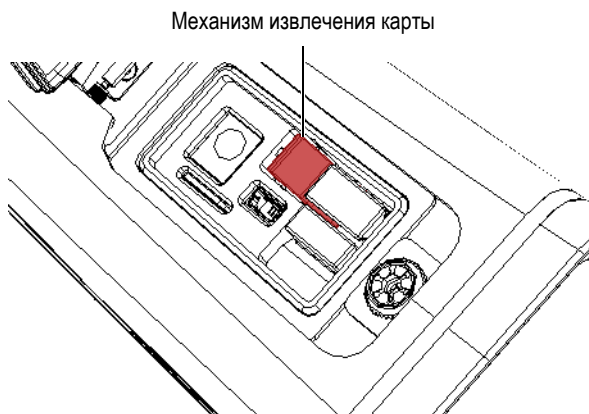
Рис. 3-8 Механизм извлечения карты
