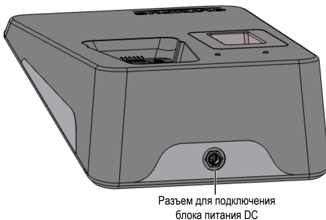
Рис. 3-14 Разъем питания док-станции (на задней панели)
