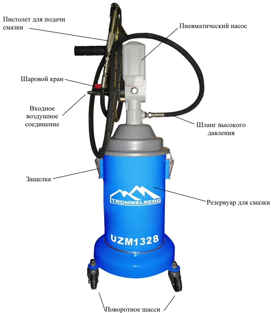
Рис. 2 Солидолонагнетатель с пневматическим насосом
