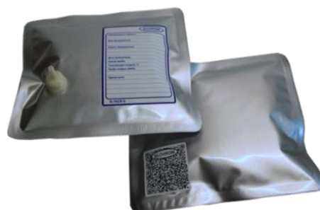
Пробоотборники с гибкой оболочкой для отбора проб газов
