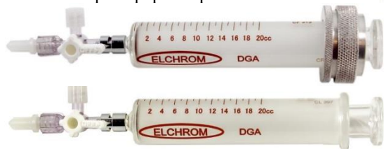
Пробоотборники с индивидуально притертыми цельностеклянными поршнями для отбора проб масла на ХАРГ
