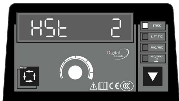
Рисунок 3. Установка времени горячего старта. Диапазон 0.2~2 сек.
