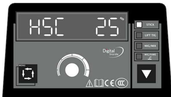
Рисунок 2. Установка тока горячего старта. Диапазон 0 ~ 50%
