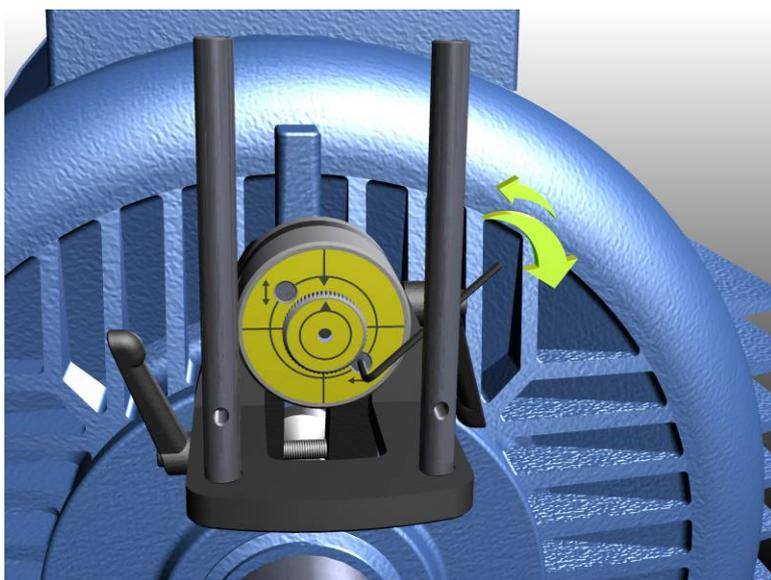
10. Повторяйте процесс сведения в конус до тех пор, пока круг, образуемый вращающимся лучом, не приобретёт форму точки на поверхности. (в пределах 2 мм).
