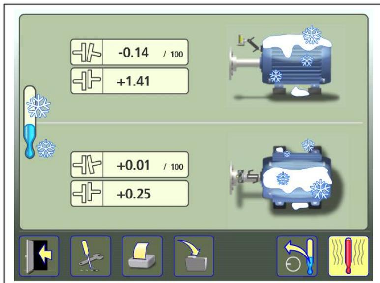
На экране результатов измерений отображаются значения расцентровки по муфте при замере в холодном режиме.
