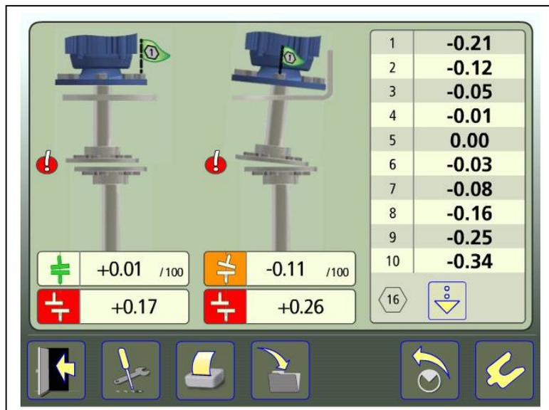
На экране результатов измерений отображаются значения расцентровки по муфте в двух перпендикулярных направлениях и расчеты положения по болтам.
