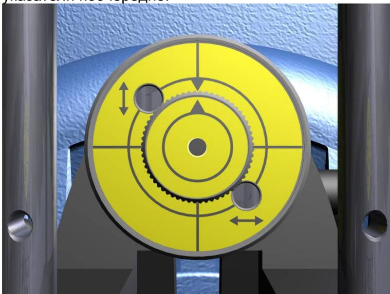
2. Поворачивайте турель на стационарной стороне и убедитесь в том, что лазерный луч падает на одну и ту же точку (в пределах 2 мм). Если этого не происходит, отрегулируйте направление лазера в соответствии с шагами 6-12.
