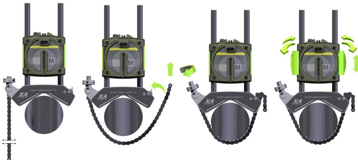
Отрегулируйте положение блоков по высоте, плавно двигая их по стойкам так, чтобы след лазерной линии оказался на приемном окне каждого из измерительных блоков. Зафиксируйте положение блоков при помощи защёлки, расположенной на задней стороне блоков.
