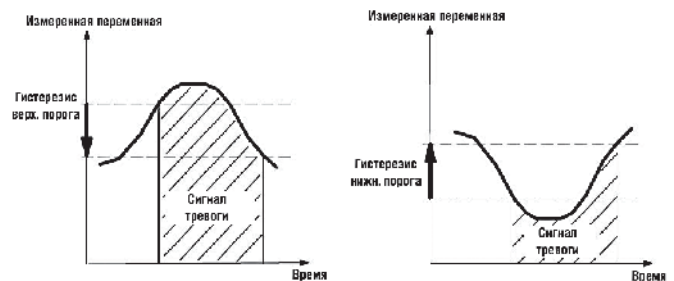
Рис.11: предупреждения о превышении пороговых значений объемного расхода и гистерезисе.
