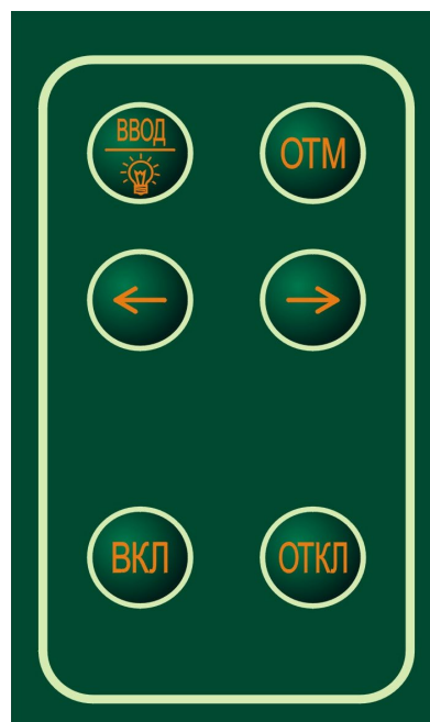
Рис. 2 — Органы управления работой фотоколориметра
