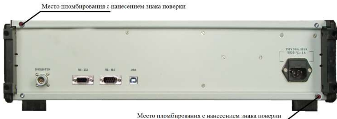
Рисунок 2 - Схема пломбирования от несанкционированного доступа
