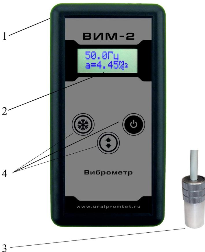
Рисунок 1 — внешний вид виброметра.
