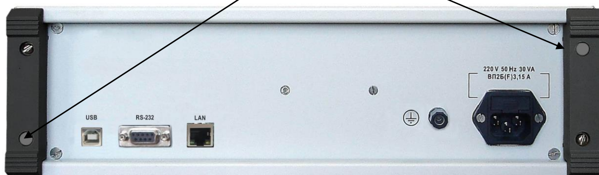
Рисунок 3 – Схема пломбировки от несанкционированного доступа, обозначение мест нанесения знака поверки
