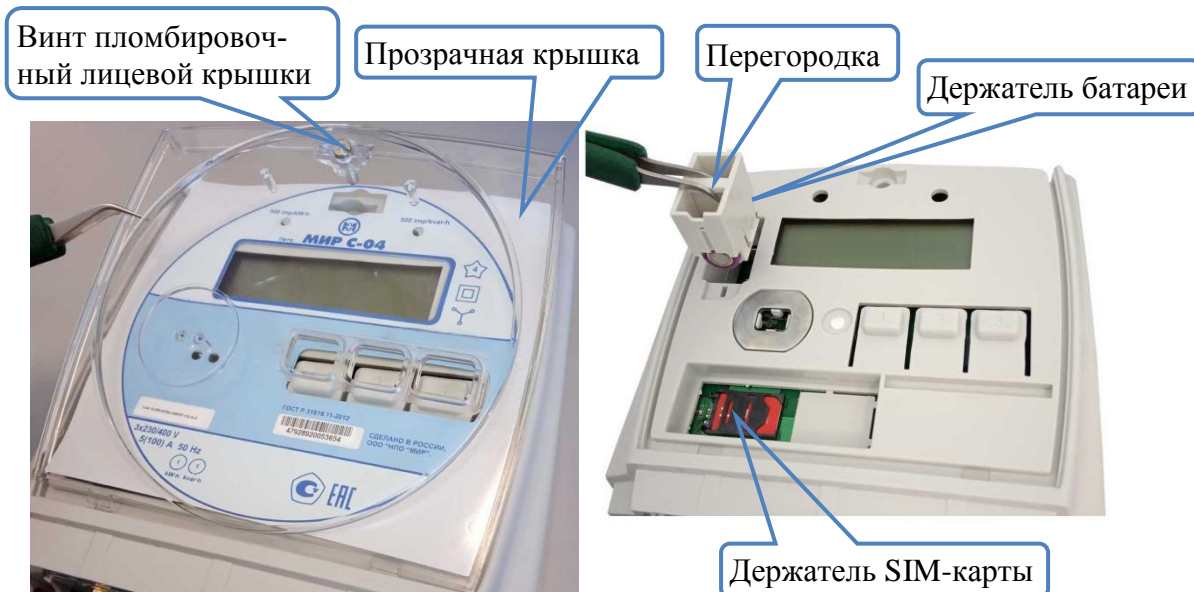
Рисунок 14.1 – Замена батареи и SIM-карты в счетчике для внутренней установки
