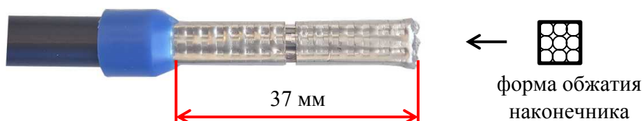
Рисунок 9.1 – Пример обжата многожильного провода для счетчиков наружной установки
