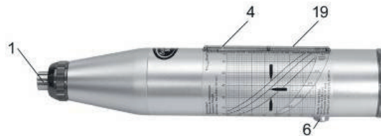
Рис. 2.4 Считывание результатов проведенного испытания по шкале (19) молотка
