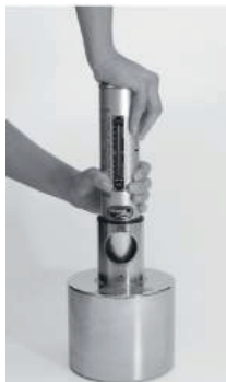
Рис. 3.1 Проверка технических характеристик молотка для контроля бетона (показан тип N/L)
