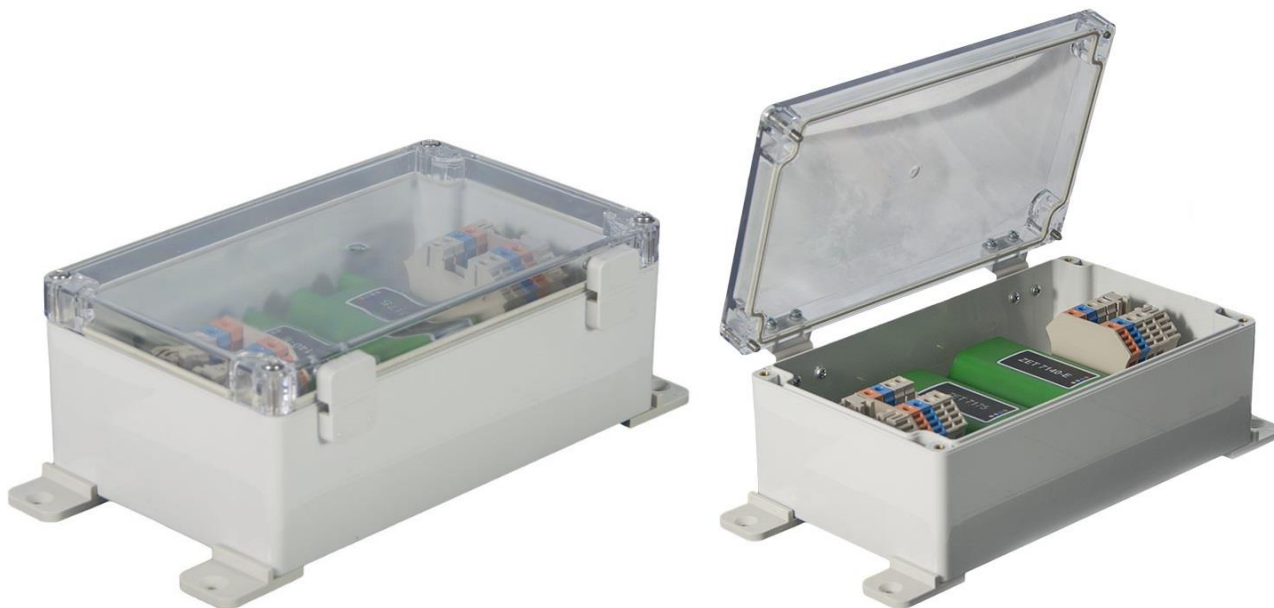
Рис. 2.2 Внешний вид преобразователя интерфейса в промышленном исполнении
