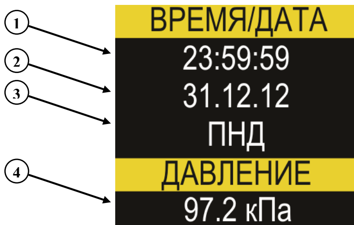
Рисунок 12 – Дисплей в режиме «Дата и время»
