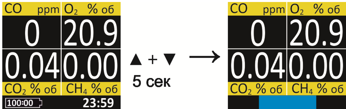
Рисунок 10 – Снятие блокировки дисплея
