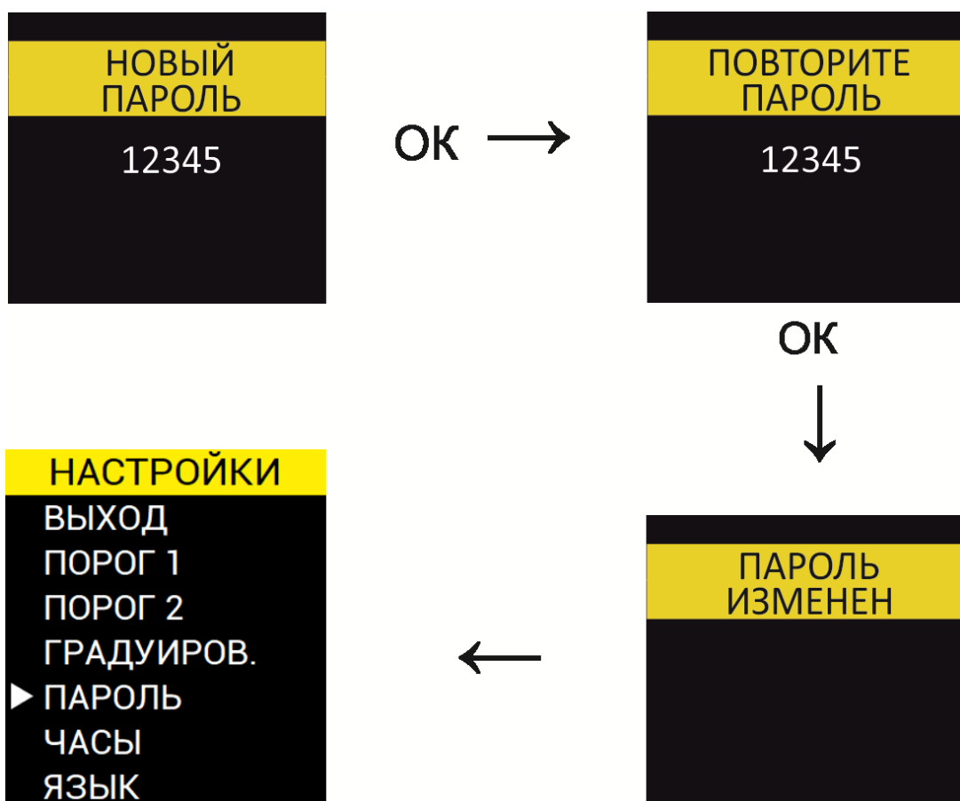
Рисунок 17 – Дисплей в режиме «Пароль»
