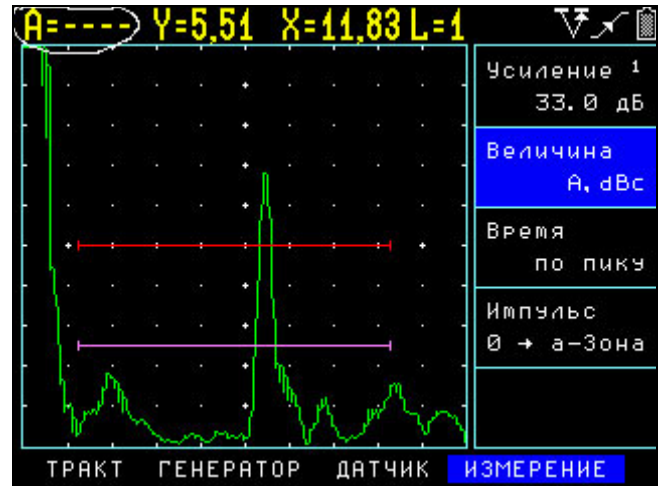
Рис.4-3 Отображение запрета на измерение амплитуды А, дБс при включенной ВРЧ
