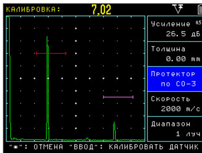
рис.3-8 Калибровка наклонного преобразователя по образцу СО-3
