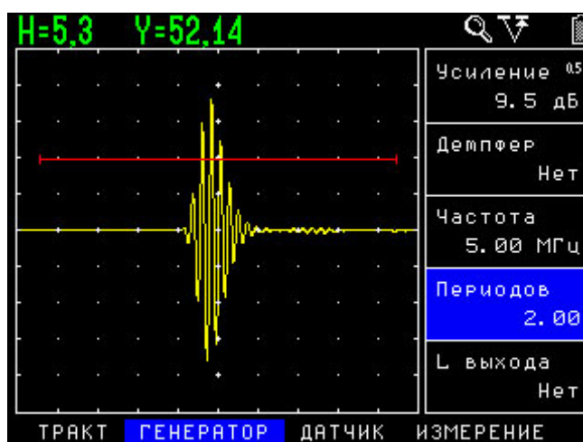
б) Возбуждение 2мя периодами частоты
