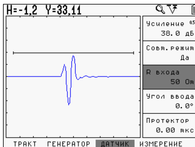
в) С включенными демпферами генератора и приемника (общий демпфер 25 Ом)
