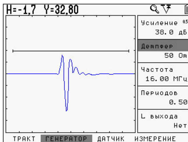
б) С демпфированием генератора 50 Ом
