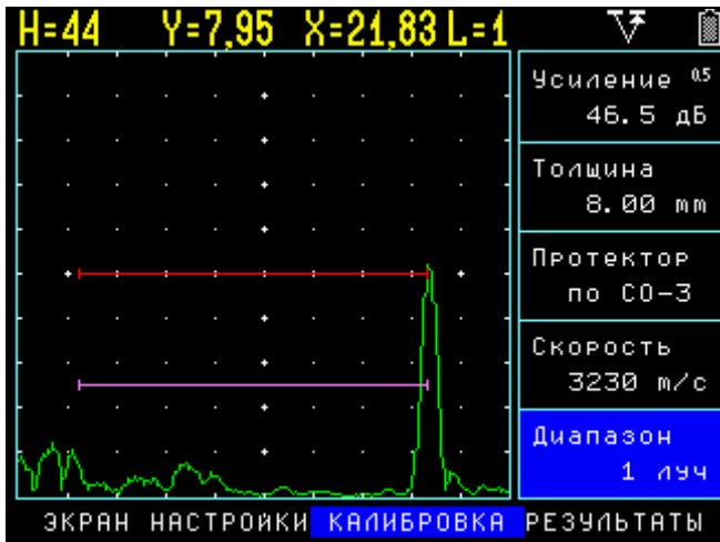
а) Калибровка диапазона для контроля прямым лучом
