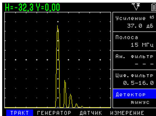
Рис.2-11 Негативное (отрицательное) детектирование
