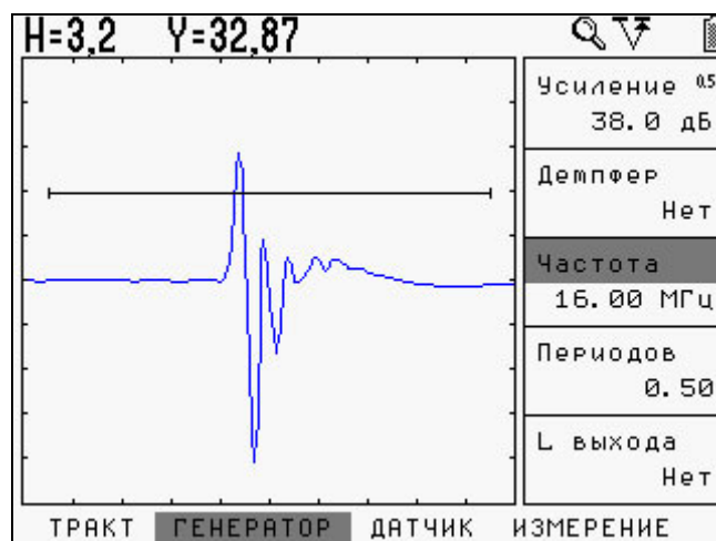
а) Широкополосный преобразователь 15МГц, подключенный без демпфирования
