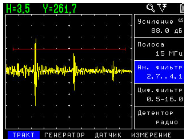
б) Сигналы после включения аналогового фильтра 2,7-4,1 МГц.
