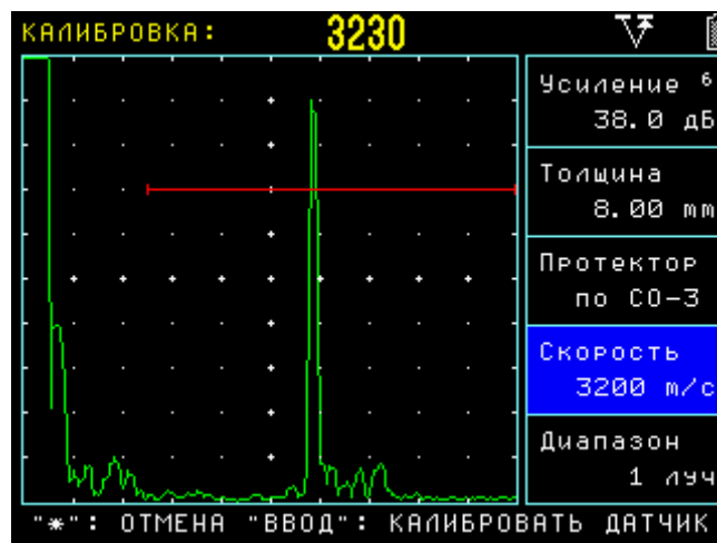
рис.3-13 Калибровка скорости в образце
