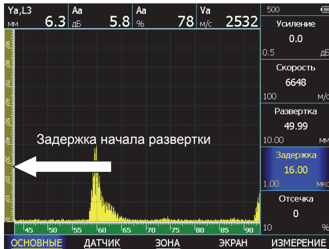
Рис.2-12 Изменение задержки начала развертки
