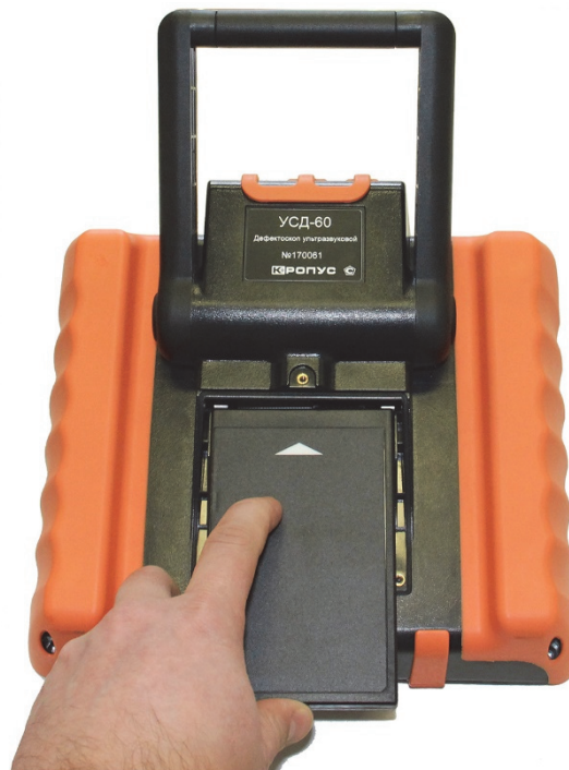
Рис.1-4 Установка нового аккумулятора
