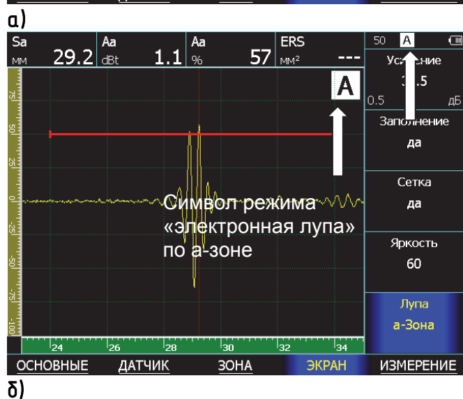
Рис.4-1 Работа в режиме 'электронная лупа'.
