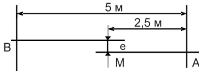
Повернуть лазерный построитель так, чтобы сместить луч приблизительно на 2,5м влево и проверить, чтобы горизонтальная линия находилась в пределах значения „точность” (см. характеристики) на той же высоте, что и нанесенная отметка, указанная лазерным крестом. Повторить эти же действия, смещая лазерный инструмент вправо. Внимание: ось вращения при проверке точности не смещайте.
