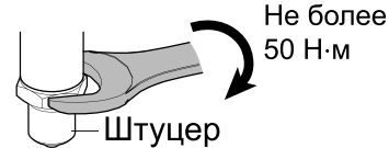
Рисунок 2 – Затягивание гайки штуцера
