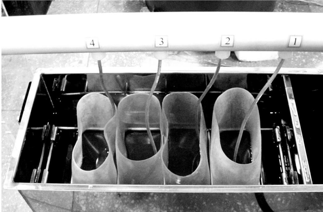
Рис. 8.14. Перчатки, подготовленные к испытанию.
