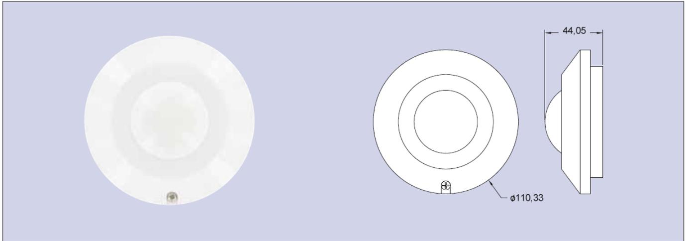
**Всенаправленный сенсор присутствия модели OSC-200** автоматически управляет вентиляционной системой HVAC (отопление, вентиляция и кондиционирование воздуха). Сферическая линза Френеля обеспечивает зону детектирования в 360° с использованием инфракрасной технологии. Встроенный процессор с двойной задержкой сохраняет энергию за счет исключения неправильной активации вследствие короткосрочного присутствия. Модель OSC-200 сконструирована для установки на потолке.
