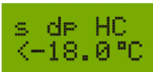
Рисунок 15. Состояние индикатора, когда dpW выше dpHC .
