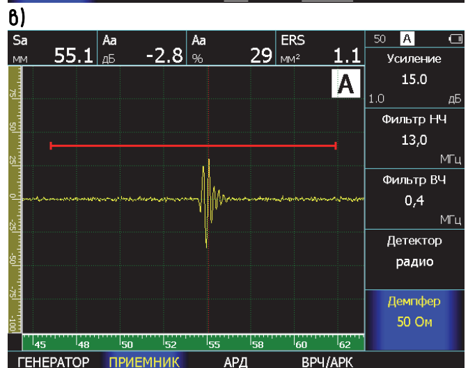
Рис.2-8 Результат применения демпфирования на ПЭП 5МГц
