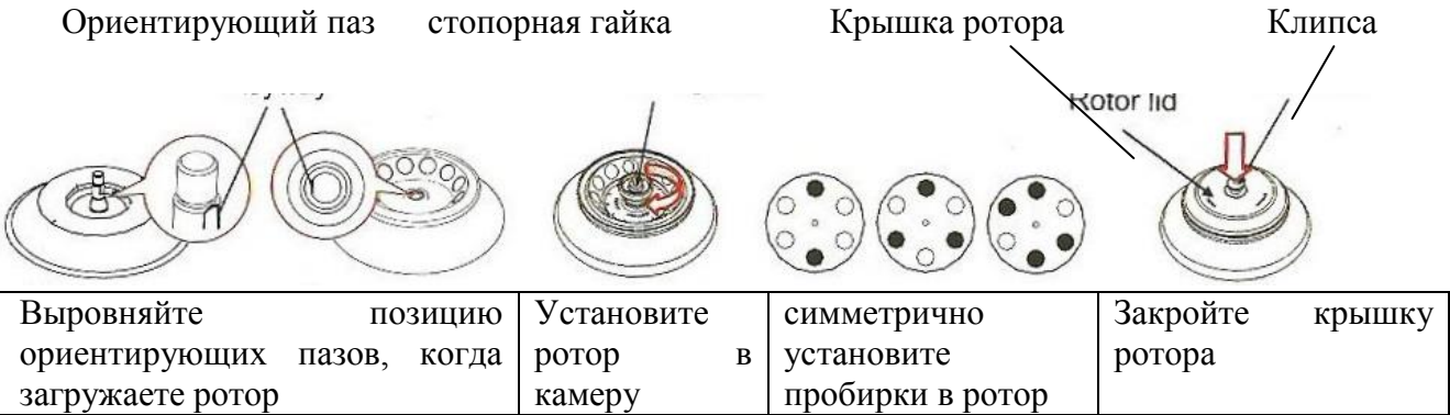
Изображение 8-2 Установка ротора
