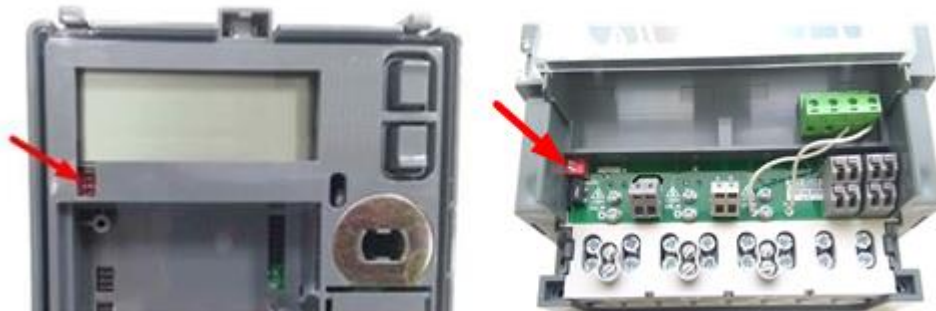
Рисунок 4.1 – Расположение переключателя блокировки управления нагрузкой счетчиков «Меркурий 204» (слева) и «Меркурий 234» (справа)
