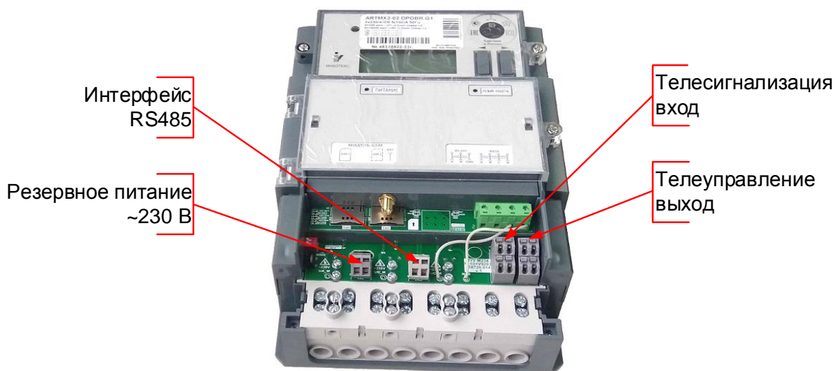
Рисунок 5.5 – Элементы подключения счетчика «Меркурий 234» с индексом «Х»
