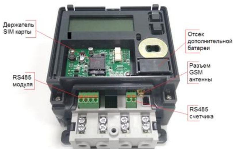
Рисунок 5.4 – Элементы подключения счетчика «Меркурий 204»
