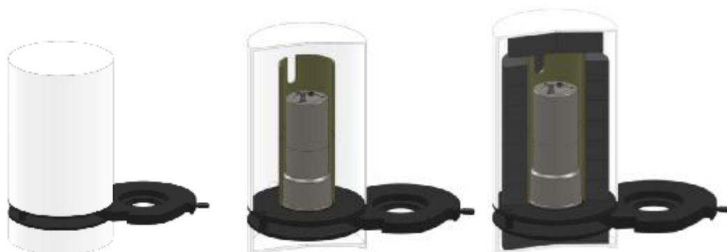
Рис. 6. Вид защитной камеры для блоков детектирования альфа- (без свинцовых колец) и бета – излучения с открытым устройством позиционирования.
