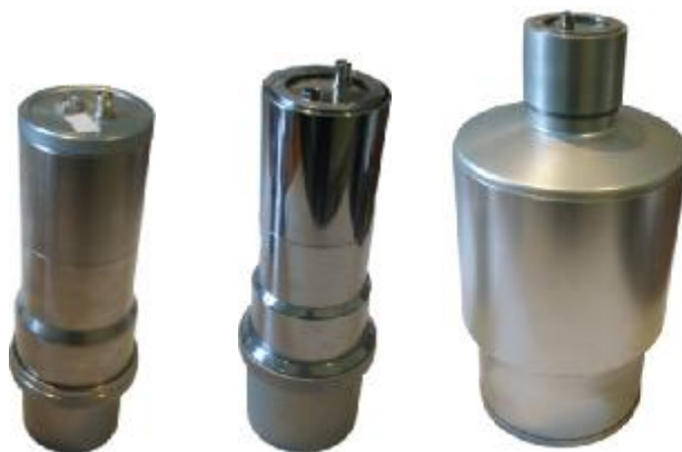
Рис. 3. Блоки детектирования гамма - излучения (БДЕГ-63, БДЕГ-80, БДЕГ-150)
