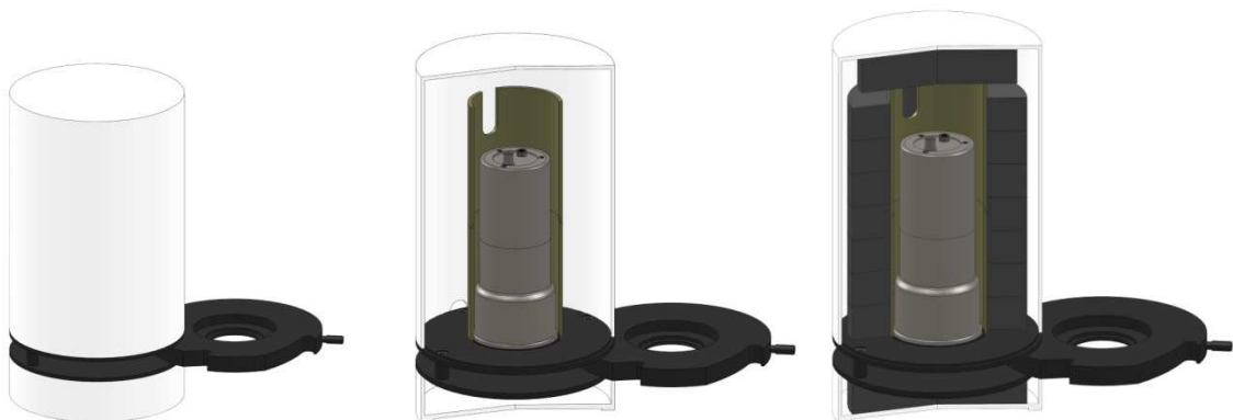
Рисунок 2.5 Вид защитной камеры для блоков детектирования альфа- (без свинцовых колец) и бета – излучения с открытым устройством позиционирования.
