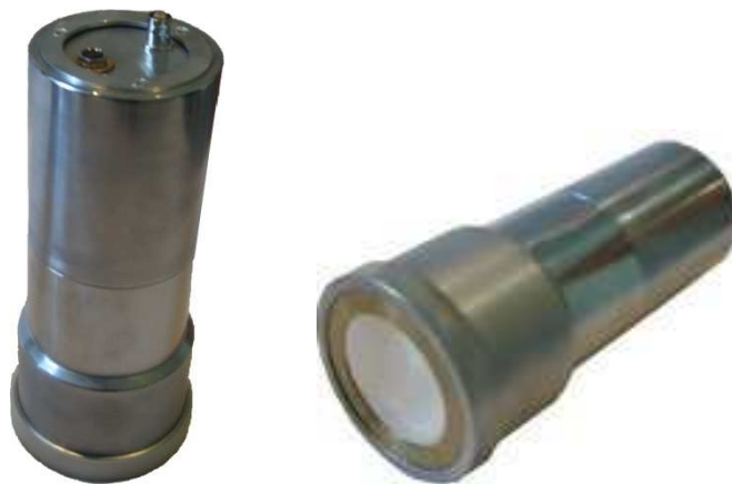
Рисунок 2.3 Блоки детектирования бета и альфа - излучения
