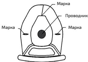
шения точности измерений проводник с током необходимо размещать в центре окружности.
