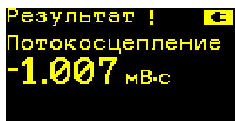
Рисунок 3.22б. Сообщение на дисплее о том, что в данных условиях есть возможность перейти на более чувствительный предел измерений
