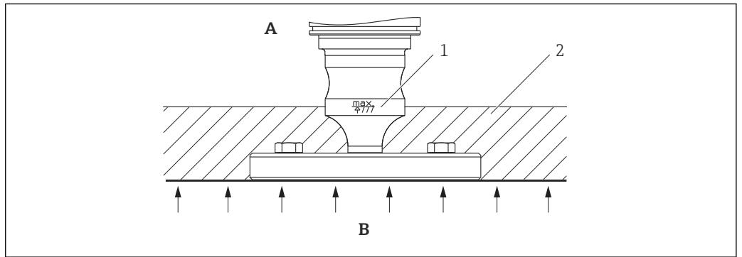
A Температура окружающей среды  $\leq 70^{\circ}\text{C}$  ( $158^{\circ}\text{F}$ )
