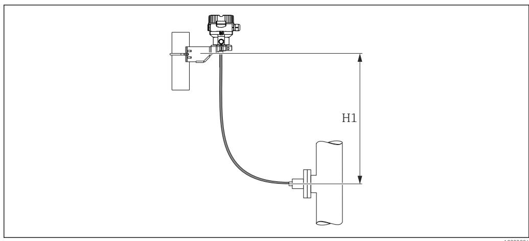
Максимальный перепад высоты зависит от плотности заполняющей жидкости разделительной диафрагмы и наименьшего допустимого давления, воздействующего на разделительную диафрагму (пустой резервуар). См. следующую иллюстрацию. На следующей диаграмме указана максимально допустимая высота установки над нижней разделительной диафрагмой для систем, работающих в условиях разрежения.
