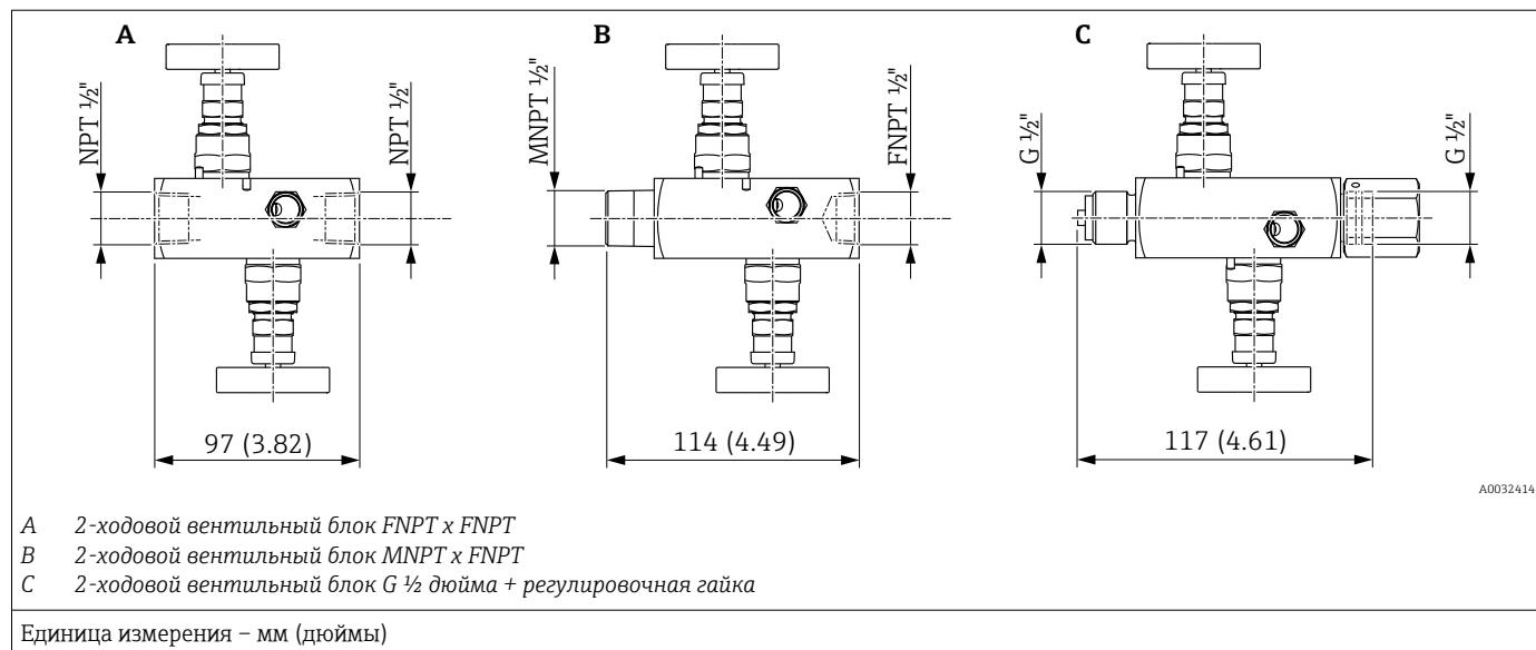
2-ходовые вентильные блоки из стали 316L сплава или AlloyC можно заказать в следующих вариантах конфигурации.
