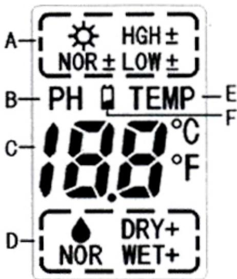
A. Область отображения интенсивности солнечного света - 9 градаций: LOW-, LOW, LOW+, NOR-, NOR, NOR+, HGH-, HGH, HGH+. Каждая из них соответствует все большему количеству света, т.е. качеству освещения. LOW- обозначает исключительно скучное и тусклое освещение. HGH+ соответствует очень яркому освещению.
