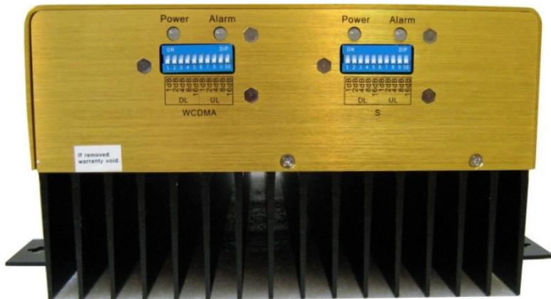
Малогабаритные DIP переключатели аттенюаторов UPLINK и DOWNLINK позволяют регулировать (в сторону уменьшения) коэффициент усиления ретранслятора раздельно в прямом и обратном направлении в диапазоне 31 дБ с шагом 1 дБ. Чтобы изменить вносимое затухание аттенюатора, необходимо перевести соответствующие рычажки переключателей в положение отличное от предыдущего (ON --затухание включено).
