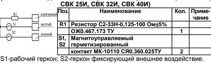
S1-рабочий геркон; S2-геркон фиксирующий внешнее воздействие.
