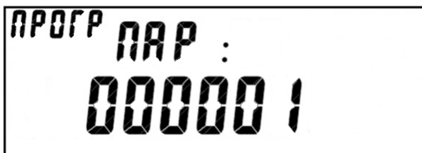
Рисунок 4.3 – Кадр с паролем доступа подключенного измерительного блока
