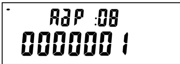
Рисунок 3.1 – Кадр с адресом измерительного блока в режиме поиска счетчика.
