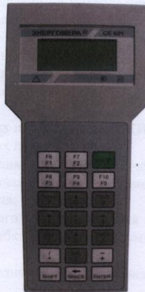
Фото 1 – Общий вид блока измерительного счетчика со стороны верхней крышки корпуса
