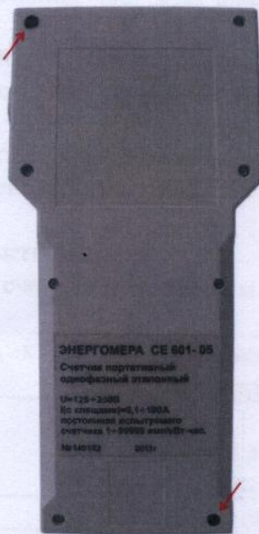
Фото 2 – Общий вид блока измерительного счетчика со стороны нижней крышки корпуса и места пломбирования на нижней крышке.
