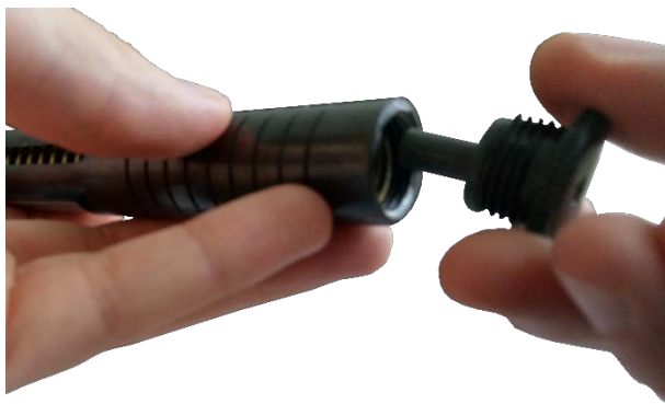
Рисунок 2.3 – Вкручивание заглушки с индентором
