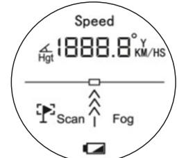
В приборе режим работы и результат измерений выводится на ЖК-дисплей, который проецируется на оптический видоискатель.
