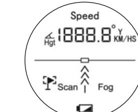
В приборе режим работы и результат измерений выводятся на ЖК-дисплей, который проецируется на оптический видоискатель.
