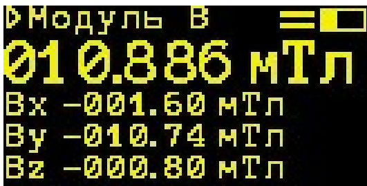
Рисунок 1.3. Режим измерения параметров постоянного магнитного поля
