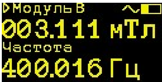
Рисунок 1.5. Режим измерения параметров переменного магнитного поля. Отображение модуля и частоты магнитного поля
