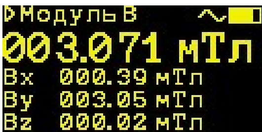
Рисунок 1.4. Режим измерения параметров переменного магнитного поля. Отображение компонентов V_x , V_y , V_z и модуля вектора магнитной индукции
