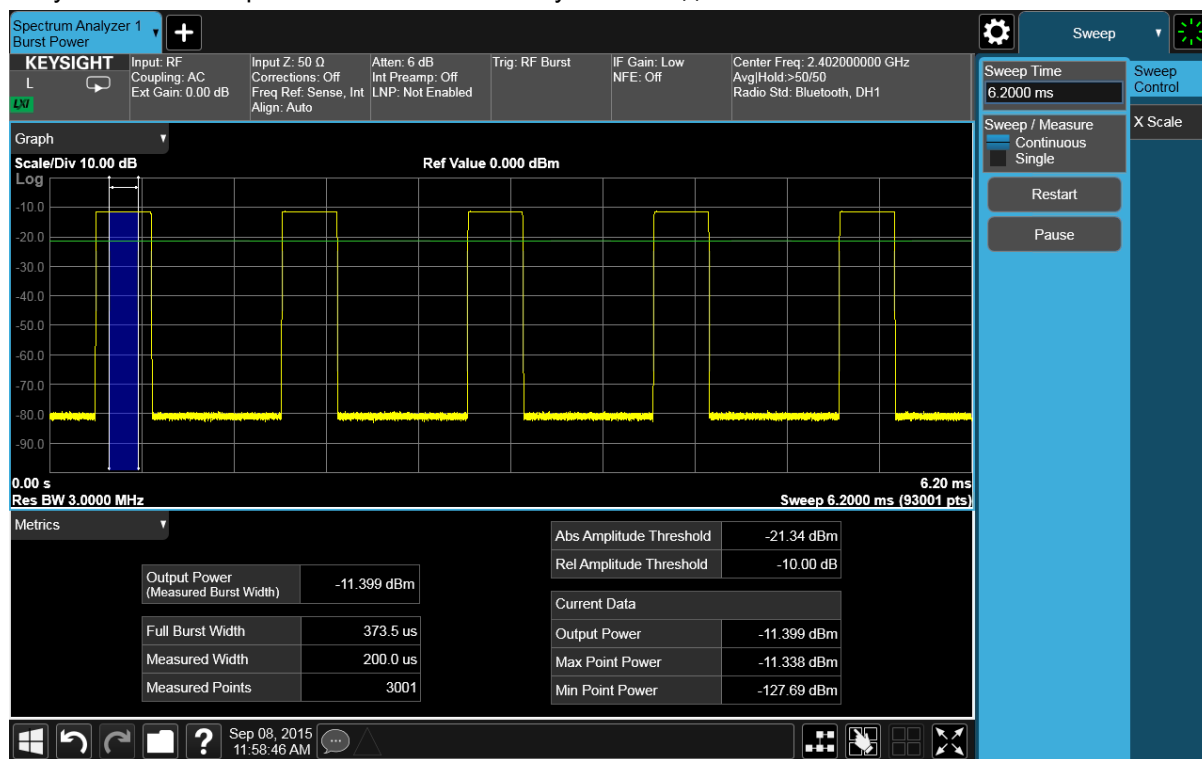
Рисунок 9-15. Отображение нескольких импульсов на дисплее
