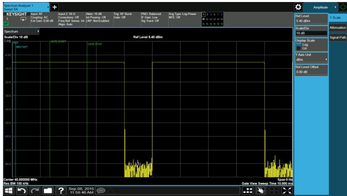
Рисунок 8-1. РЧ-сигнал со стробированием
