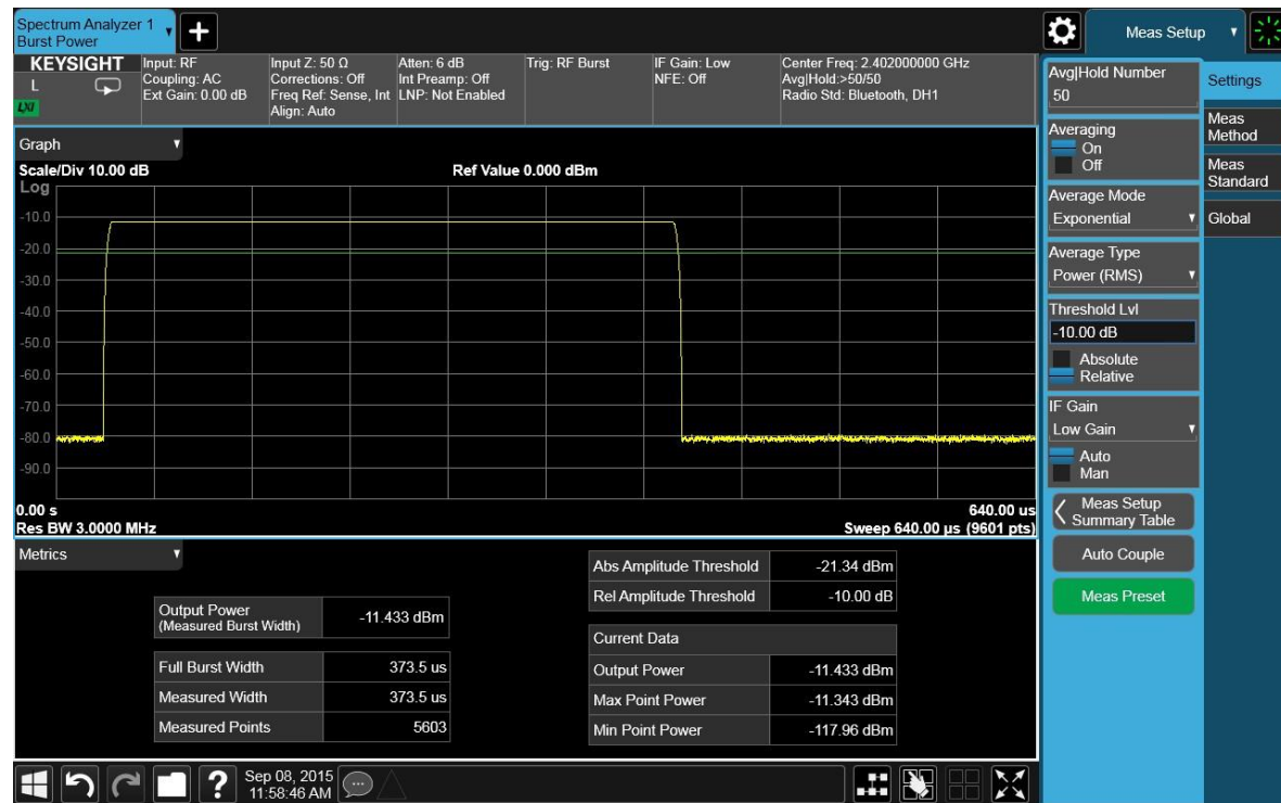
Рисунок 9-13. Результаты измерения мощности импульса при установленном пороговом уровне
