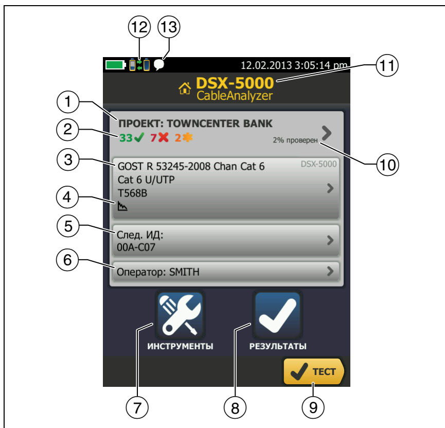
Рис. 3. Главный экран для DSX CableAnalyzer
