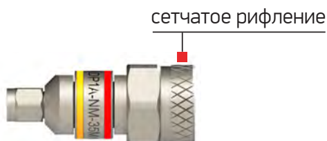
N, вилка – сетчатое рифление 3,5 мм, вилка – нет маркера
