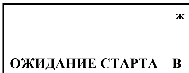
Рисунок 34 - Изображение информации на ЖК дисплее в режиме измерения временных интервалов
