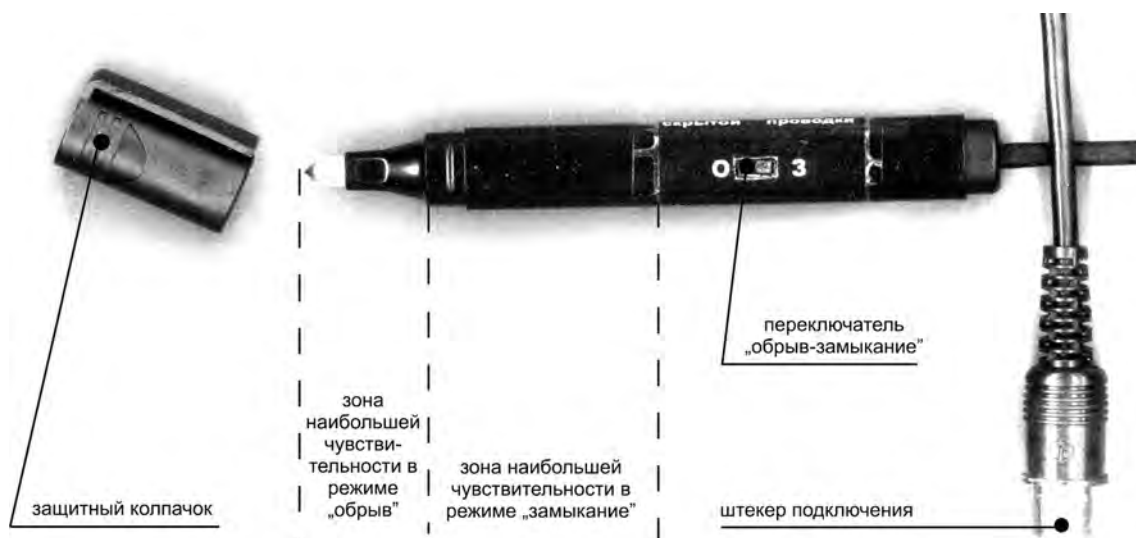
Рисунок 5.3.4.1 – Мини-датчик МД-01
