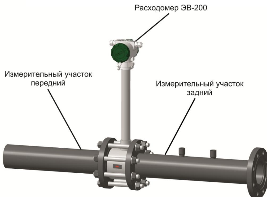
Рисунок 2.1 – Схема монтажа преобразователя расхода
