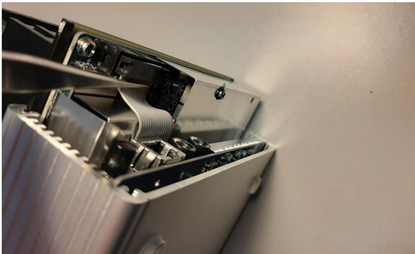
5. Потяните радиатор до середины корпуса, не тяните сильно, чтобы не повредить кабели соединяющие усилитель и плату SDR
