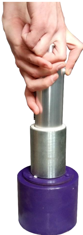
Рисунок 2.1 – Проверка молотка Шмидта на эталонной наковальне
