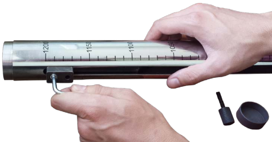
Рисунок 2.1 – Установка ударника внутрь направляющей трубы
