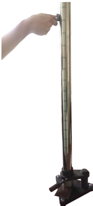
Рисунок 2.3. – Установка груза на необходимой высоте
