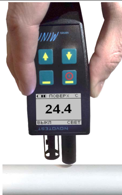
Рисунок 2.4 – Изображение прибора при измерении температуры поверхности
