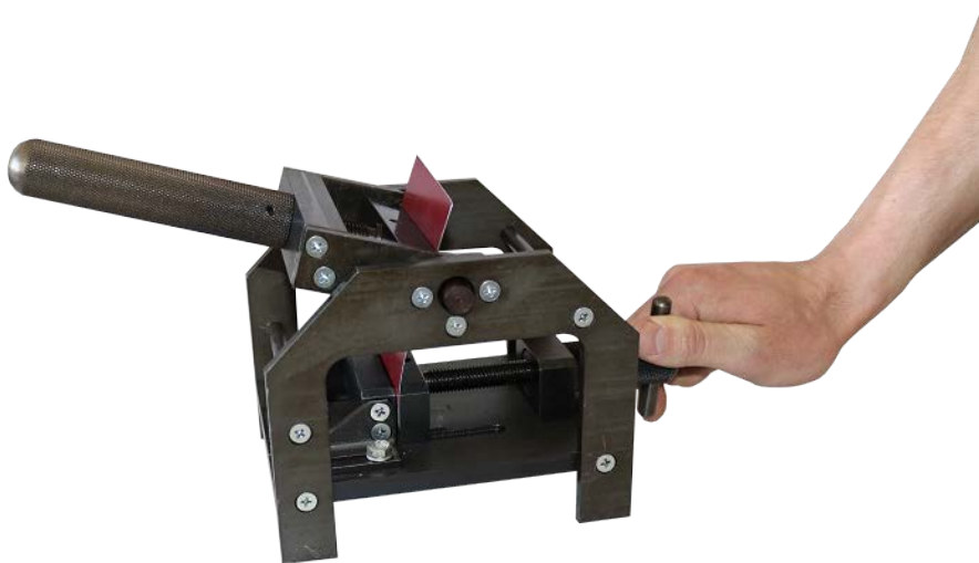
Рисунок 2.1 – Фиксация испытательной пластинки
